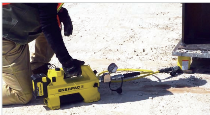
▲ RCS-302 単動シリンダを使ってジャッキアップしています。
