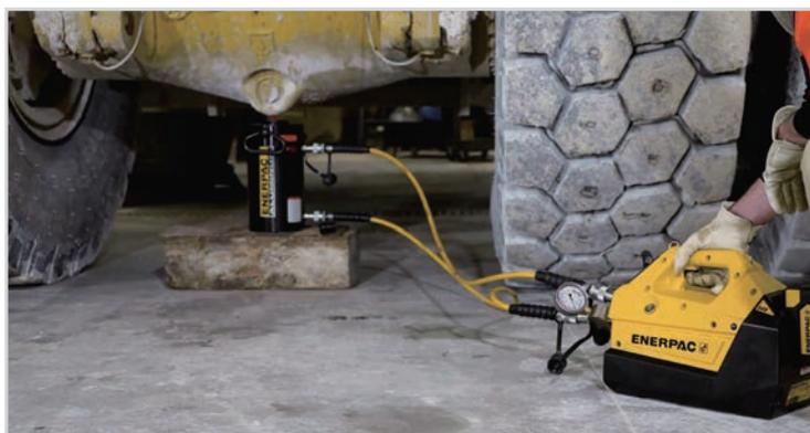
▲ RAR-1004 型 1002kN 複動シリンダを使って大型工事用車両のメンテナンスに XC2404MBN が使用されています。
